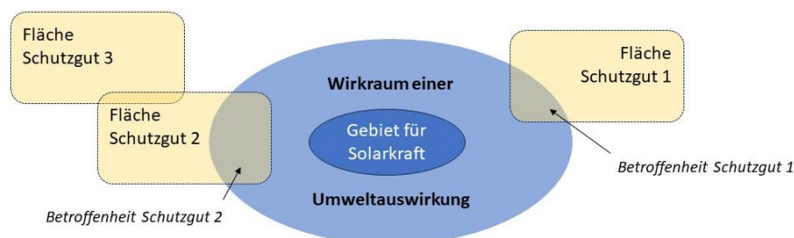
Abbildung 1: Schematische Darstellung der grundsätzlichen Vorgehensweise zur Ermittlung der Betroffenheit von Schutzgütern. (verändert nach RVNA).
